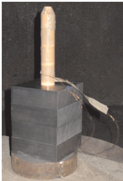
Rys. 1. Zdjęcie układu służącego do pośredniego pomiaru ciśnienia detonacji — badany ładunek ustawiony na stosie stalowych płyt
