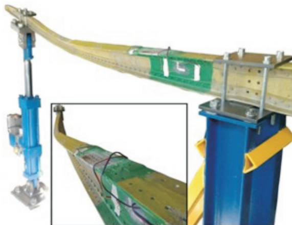
Rys. 22. Deformacja dźwigara w wyniku niekontrolowanego przemieszczenia się siłownika
