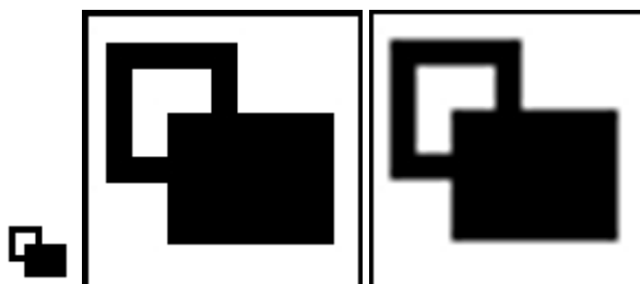
Rys. 22. Obraz powiększony 4 razy, z lewej oryginal, w środku powiększony metodą autorską, z prawej dwusześcienną
