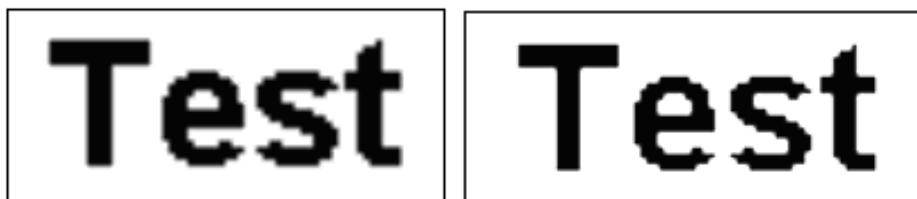
Rys. 15. Po lewej stronie obraz „Test” otrzymany z wykorzystaniem funkcji interp2 (interpolacja dwusześcienna), z prawej zsumowany z krawędziami
