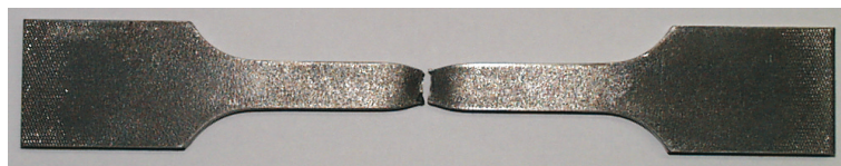
Rys. 4. Widok próbki płaskiej po zerwaniu
