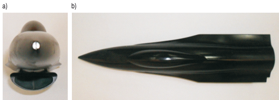
Rys. 8. Model układu wlotowego silnika i przedniej części samolotu F-16: a) widok z przodu modelu; b) widok z góry modelu
