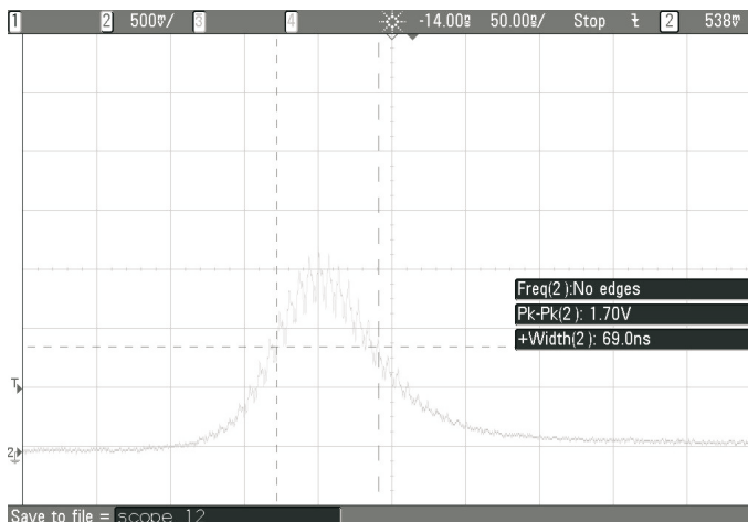
Rys. 14. Oscylogram kształtu monoimpulsu o czasie trwania 69 ns (FWHM) uzyskanego przy energii pompy 8,2 J i transmisji zwierciadła wyjściowego 52%
