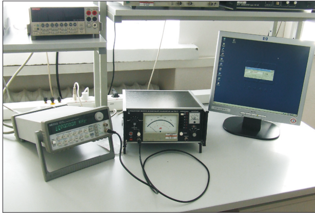
Rys. 4. Stanowisko do kalibracji mierników zniekształceń nieliniowych
