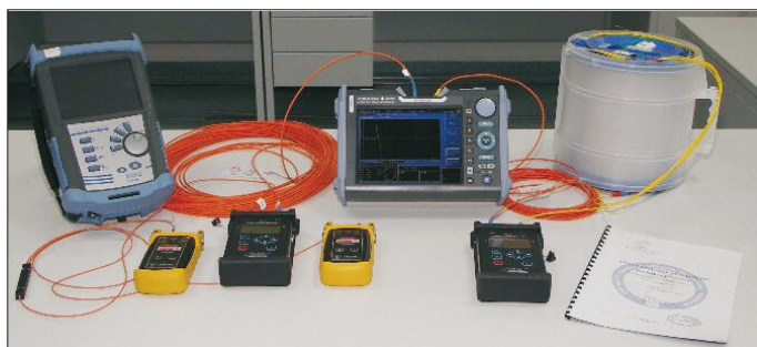
Rys. 5. Widok stanowiska pomiarowego do kalibracji reflektometrów
