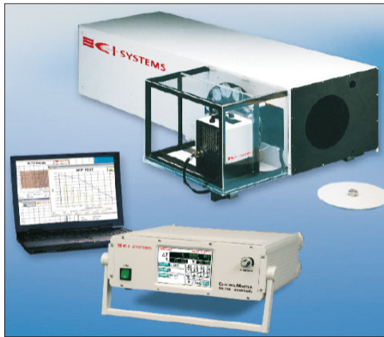
Rys. 2. Zdjęcie stanowiska do pomiaru parametrów obserwacyjnych kamer termowizyjnych [9]
