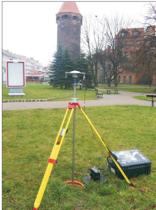
Rys. 4. Sposób ustawienia anteny GPS na punkcie kontrolowanym przy użyciu przyrządu do precyzyjnego wymuszonego centrowania anteny GPS, patent UWM nr 90-402/45/2007
