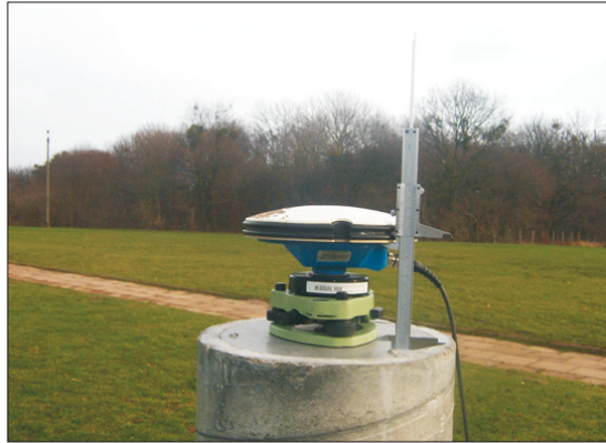
Rys. 3. Pomiar wysokości anteny GPS suwmiarką, względem jednego z trzech punktów odniesienia znajdujących się w głowicy znaku punktu referencyjnego
