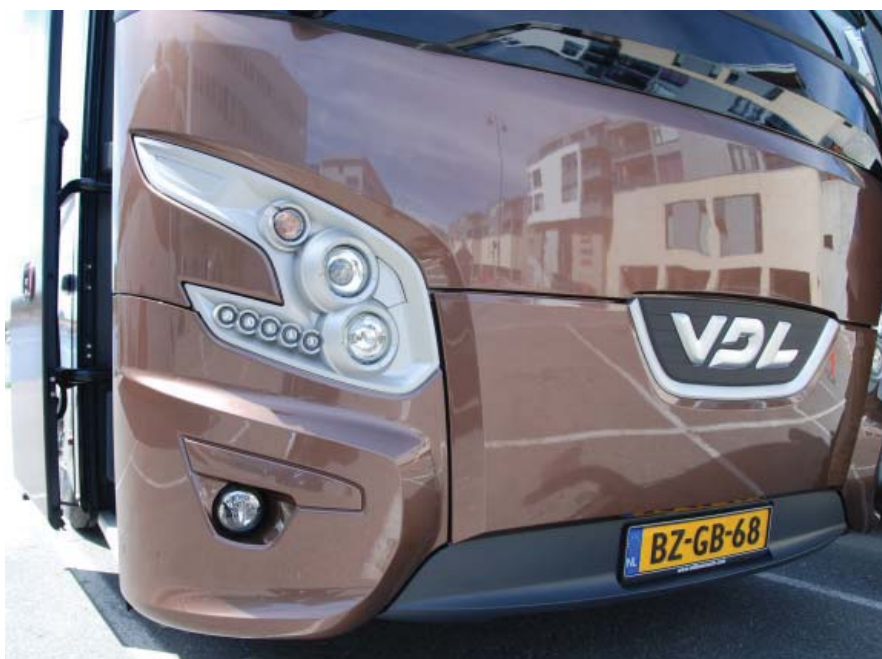
Panel przedni oraz zderzaki wykonane zostały z PDCPD (polydicyclopentadianu)
