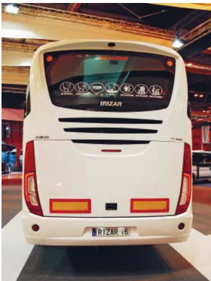
Spojler z kamerą cofania i światłami hamowania typu LED
