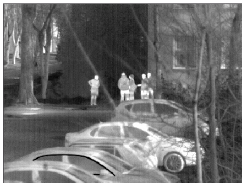
Rys. 5. Przykład obrazu termowizyjnego uzyskany z matrycy mikrobolometrycznej za pomocą opracowanego układu odczytu (teren WAT, 03.2009)
