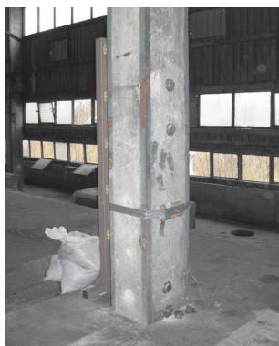
Rys. 11. Usytuowanie czujników MCC rejestrujących ciśnienie
