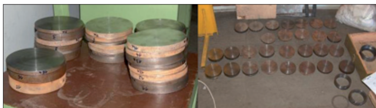
Rys. 2. Próbkę ze stali 10GHMBA do badań kuloodporności na wahadle balistycznym
