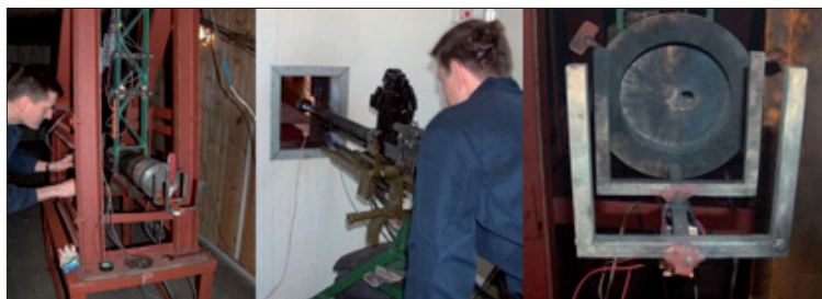
Rys. 3. Przestrzeliwanie próbek ze stali 10GHMBA w jamie strzelniczej
