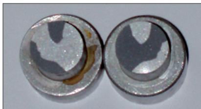
Rys. 15. Przykład typowo adhezyjnego zniszczenia połączenia klejowego
