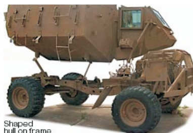
Rys. 2. Przykład konstrukcji pojazdu, w którym osłonę umieszczono nad ramą nośną
