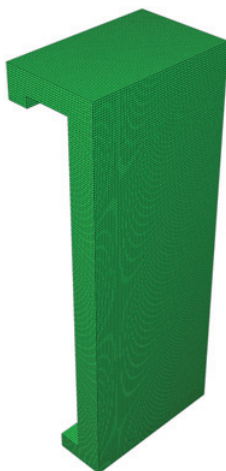
Rys. 5. Siatka elementów skończonych konstrukcji żelbetowej
