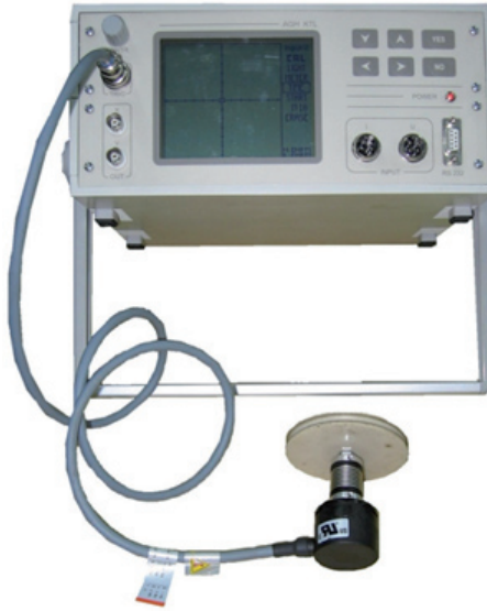
Rys. 5. Analizator położenia XY z podłączonym enkoderem
