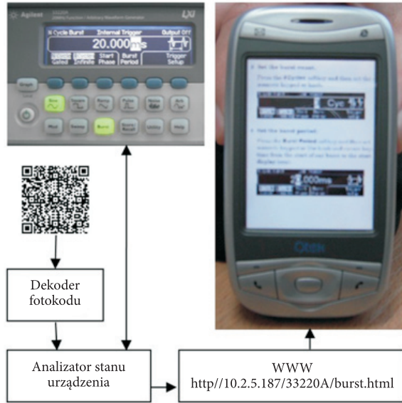
Rys. 10. Wspomaganie obsługi generatora — funkcja „burst”
