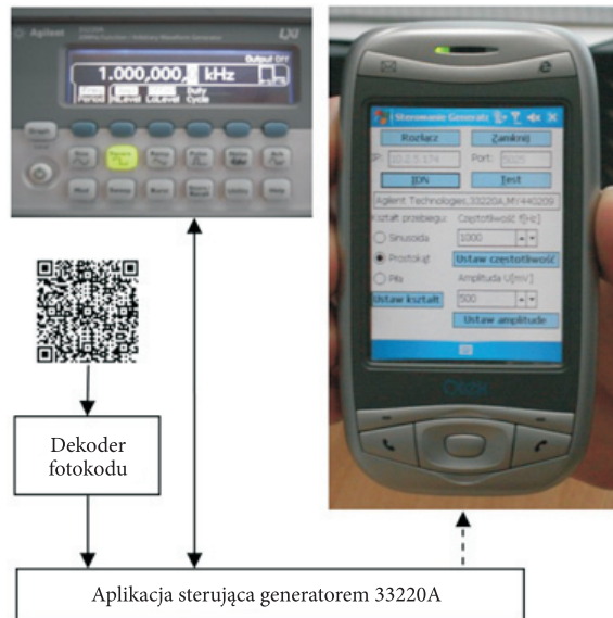
Rys. 11. Sterowanie generatorem z PDA
