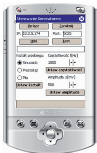
Rys. 5. Oprogramowanie dla generatora 33220A na PocketPC
