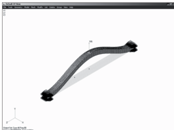
Rys. 2. Model MES przewodnika
