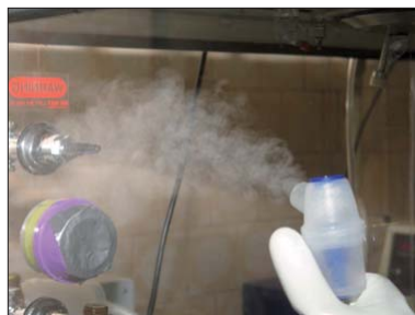
Rys. 2. Rozpylanie bioaerozolu — widok głowicy nebulizatora
