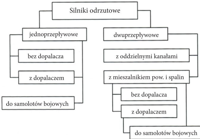
Rys. 3. Klasyfikacja turbinowych silników odrzutowych
