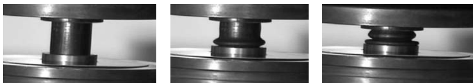
Rys. 3. Proces ściskania rurki o długości początkowej 35 mm [3]
