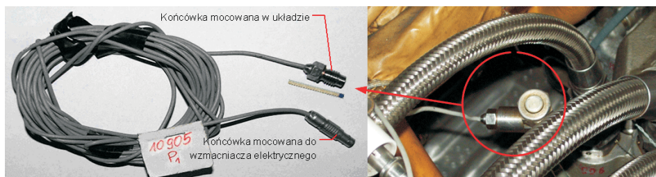
Rys. 6. Piezorezystancyjny czujnik Endevco zamontowany w układzie hydraulicznym
