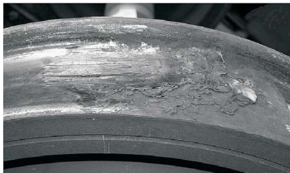
Rys. 9. Płaskie miejsce na kole wagonu towarowego
