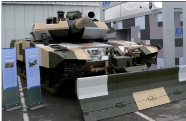
Fot. 1.2. Niemiecki czołg Leopard 2A6 wyposażony w dodatkowe elementy opancerzenia w wersji do prowadzenia działań bojowych w terenie zurbanizowanym
