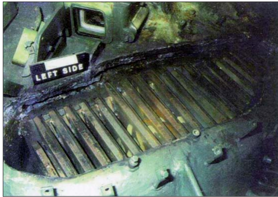
Fot. 1.1. Panczer warstwowy wieży rosyjskiego czołgu T72-B
