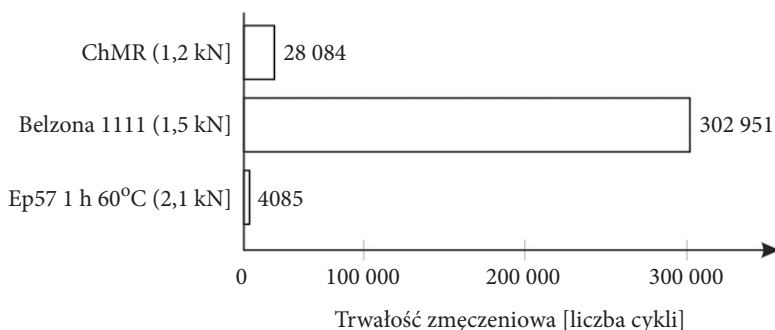
Rys. 9. Porównanie względnej trwałości zmęczeniowej na ścinanie (maksymalne obciążenie cyklu zmęczeniowego równe ~0,66 wartości siły niszczącej) różnych tworzyw adhezyjnych (próbki jednozakładowe ze stopu aluminium, powierzchnie przygotowane do klejenia metodą piaskowania)
