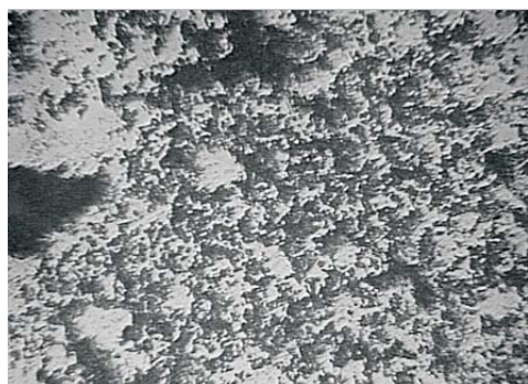
Rys. 3.2. Zdjęcia metalograficzne próbek 95W-5Re spiekanych w próżni (temperatura 1500°C, czas 2 godziny): a) z mieszanki nanometrycznej; b) z mieszanki mikrometrycznej — pow. 2000×
