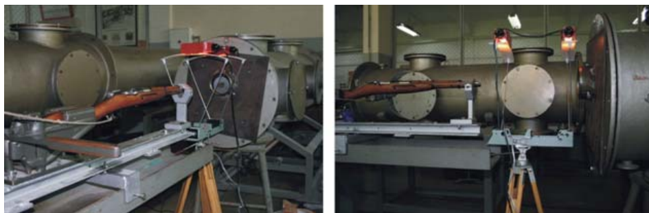
Rys. 4. Stanowisko do dynamicznego odkształcania próbek walcowych
