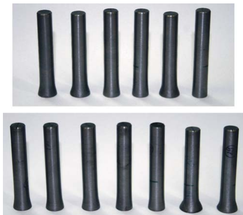
Rys. 6. Widok próbek walcowych po przeprowadzeniu testu Taylora
