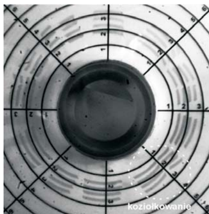
Rys. 11. Zestawienie położenia elementów pierścienia w wybranych czasach ilustrujące koziołkowanie fragmentów
