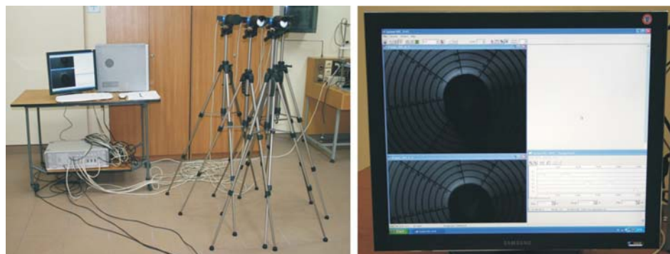
Rys. 4. Stanowisko laboratoryjne do fotograficznej rejestracji procesu rozciągania i fragmentacji pierścieni (widok od strony cewki z pierścieniem) oraz przykładowy widok ekranu dialogowego
