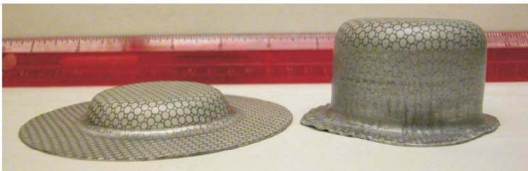
Rys. 1. Porównanie zdolności do kształtowania plastycznego blachy stalowej odkształcanej tradycyjną metodą tłoczenia (element z lewej) oraz techniką elektromagnetyczną (element z prawej) [7]
