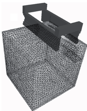
Rys. 4. Przykładowa geometria trójwymiarowego modelu przetwornika
