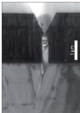
Rys. 8. Pęknięcia w warstwie azotku galu powstałe w wyniku niedopasowania stałych sieci krystalicznej osadzonej warstwy GaN i podłoża
