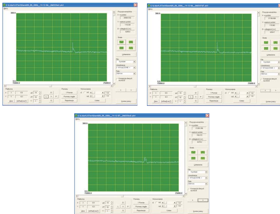
Rys. 12. Sygnały uzyskane od rozwarstwionej chmury, dla fali długości \lambda_1 = 1064 nm. Chmura znajdowała się na wysokości ok. 6400 m. Trzy kolejne wykresy pokazują zmiany w czasie
