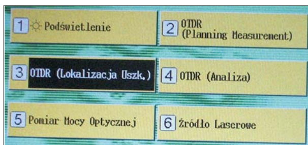
Rys. 5. Ekran przyrządu — Menu główne (wybór funkcji)
