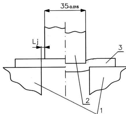
Rys. 2. Schemat przyrządu do odcinania: 1 — noże tnące; 2 — stempel; 3 — próbka; L_j — szczelina wykrawania
