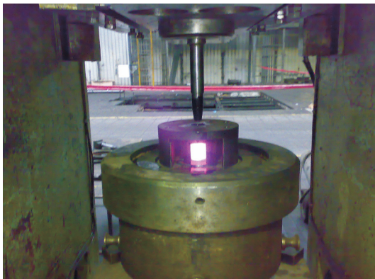
Rys. 6. „Przygotówka”, po wyjęciu ze wzbudnika umieszczona w gnieździe matrycy
