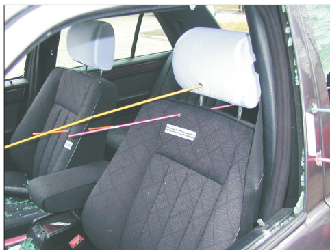
Rys. 5. Przykładowe oznaczenie śladów podczas identyfikacji pocisków strzeleckich (badania własne)
