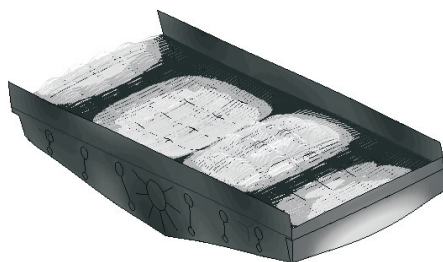
Rys. 13. Dwudziesta trzecia postać drgań własnych przesiewacza
