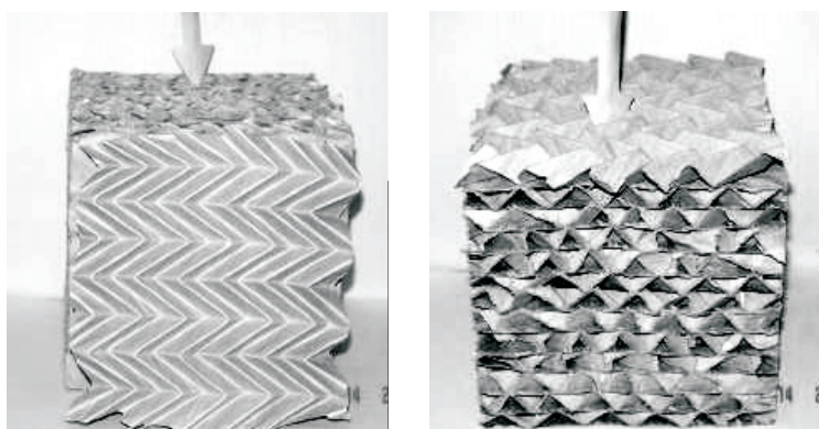
Rys. 9. Obciążenie prostopadłe i wzdłuż krawędzi zestawu struktur pofałdowanych [3]
