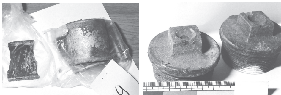
Rys. 2. Zabezpieczone na miejscu wybuchu korki hydrauliczne i fragmenty bocznych ścianek mufy wypełnionej mieszaniną pirotechniczną
