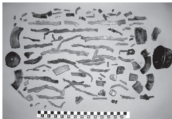
Rys. 11. Odłamki odzyskane po detonacji ładunku trotylu łuskowanego
