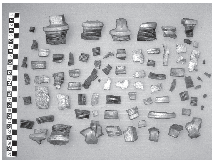
Rys. 6. Fragmenty mufy po wybuchu mieszaniny TNT/P4
