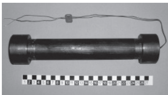
Rys. 9. Zdjęcie rury stalowej z materiałem wybuchowym przed próbą
