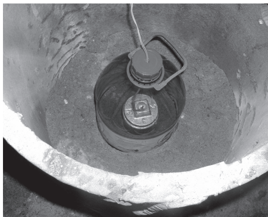
Rys. 4. Położenie elementów układu eksperymentalnego przed zasypaniem warstwą piasku
