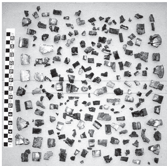
Rys. 7. Fragmenty mufy po detonacji mieszaniny SA/Al
