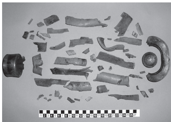
Rys. 10. Odłamki odzyskane po wybuchu ładunku ANFO
