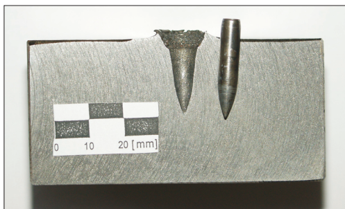
Rys. 1. Przekrój krateru i widok pocisku
