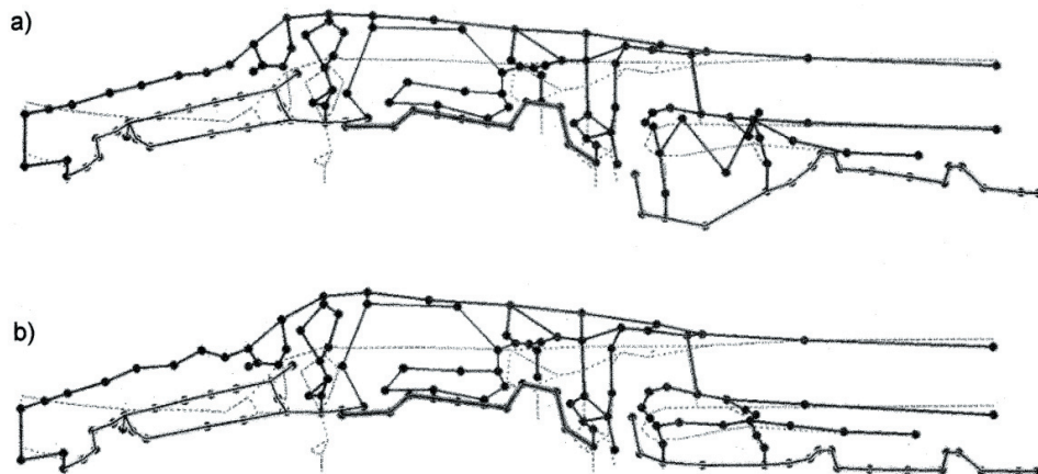
Rys. 3.6. Pierwsza postać drgań silnika PZL-10W na anizotropowej przedniej podporze: a) drgania w płaszczyźnie (Oxz), \Omega_1 = 465,4 Hz; b) drgania w płaszczyźnie (Oxy), \Omega_1 = 459,2 Hz
