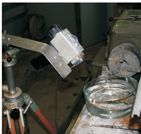
Rys. 1. Fragment stanowiska z pistoletem plazmowym i pojemnikiem z wodą
