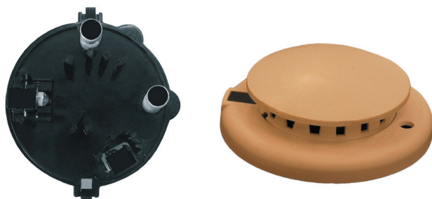
Rys. 9. Zdjęcia komory dymnej (a) oraz kompletnego czujnika dymu (b) opracowanego w Wojskowej Akademii Technicznej
