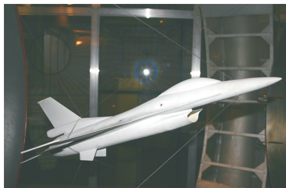
Fot. 2. Model samolotu w konfiguracji „gładkiej” zawieszony w tunelu
