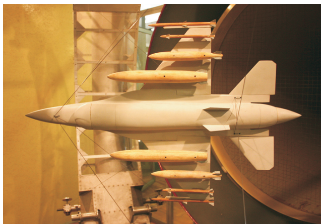
Fot. 11. Model samolotu z modelami: rakiet AIM-120, AIM-9, bomb i zbiorników podwieszanych („5”)
