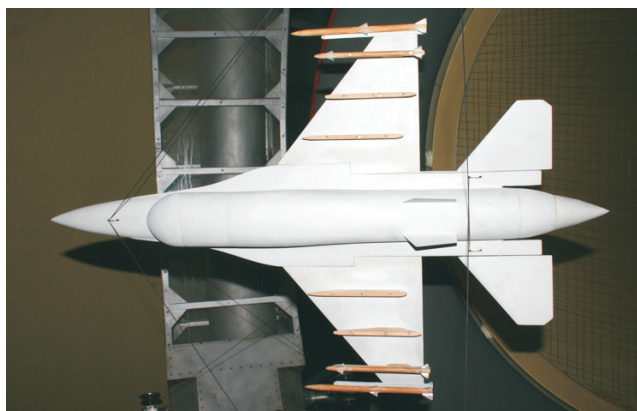
Fot. 9. Model samolotu z modelami rakiet : AIM-120 i AIM-9 („3”)
