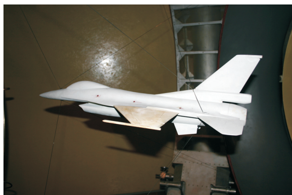
Fot. 6. Model samolotu w konfiguracji przelotowej — duże prędkości
