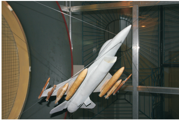
Fot. 1. Model samolotu F-16 w tunelu aerodynamicznym do badań w opływie niesymetrycznym
