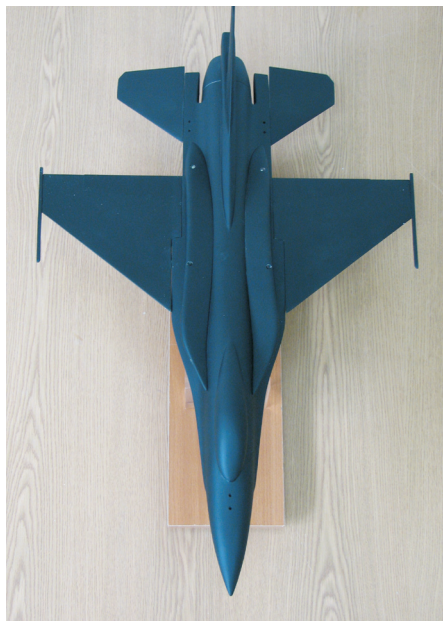
Fot. 12. Model samolotu ze zbiornikami konforemnymi („6”)
