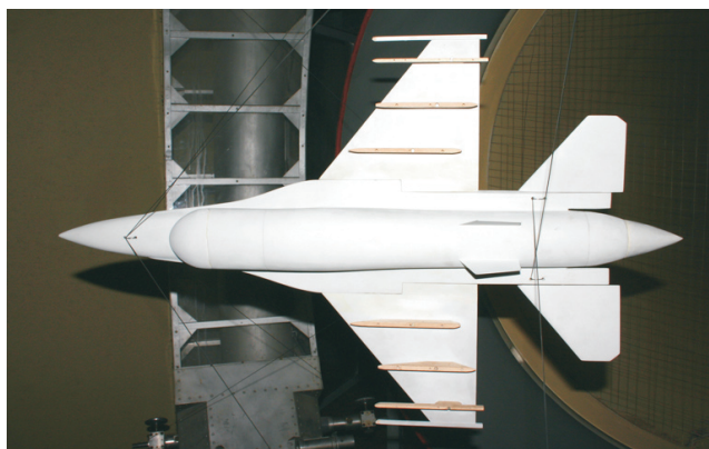
Fot. 7. Model samolotu z belkami podskrzydłowymi („1”)
