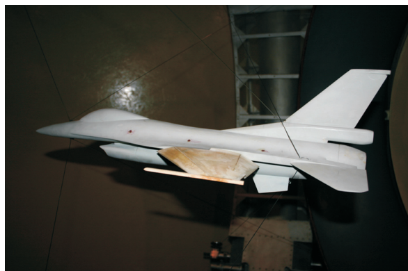
Fot. 4. Model samolotu w konfiguracji startowej — oderwanie
