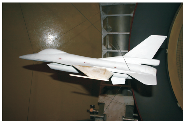
Fot. 3. Model samolotu w konfiguracji startowej — kołowanie
