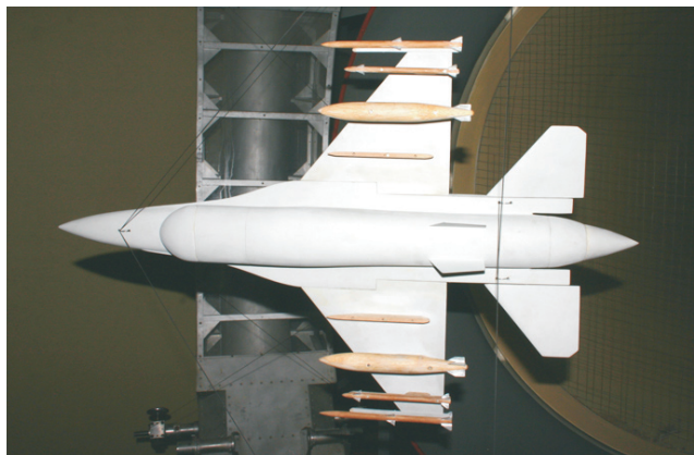
Fot. 10. Model samolotu z modelami: rakiet AIM-120, AIM-9 i bomb („4”)
