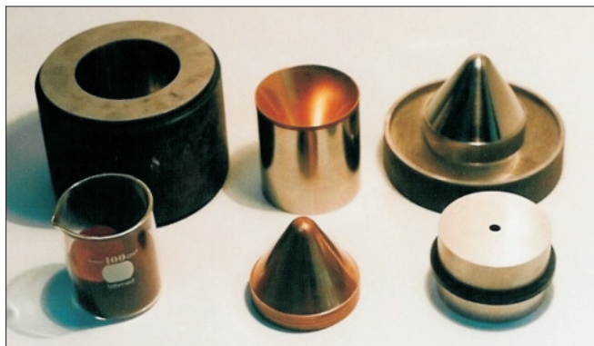
Rys. 6. Widok zestawu oprzyrządowania do prasowania wkładek kumulacyjnych z proszków metali
