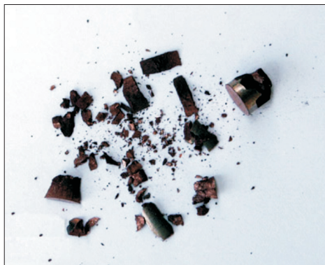
Rys. 4. Fragmenty próbki walcowej po próbie ściskania (ciśnienie prasowania — P_2 , temperatura spiekania — T_2 )
