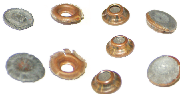
Rys. 19. Elementy pocisku Parabellum z rdzeniem ołowianym po zderzeniu prostopadłym z tarczą stalową
