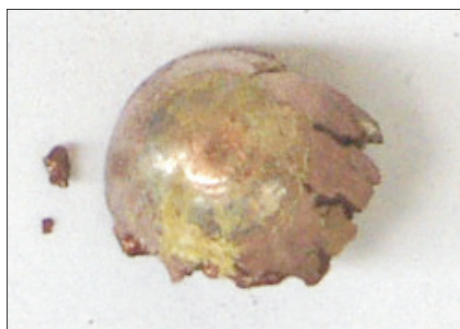
Rys. 15. Fotografia odłamka powstałego z wierzchołkowej części pocisku — największy odzyskiwany fragment
