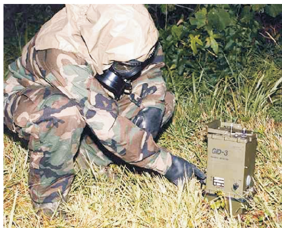
Fot. 3. Przyrząd pokładowo-wyноśny GID-3 do wykrywania BST
