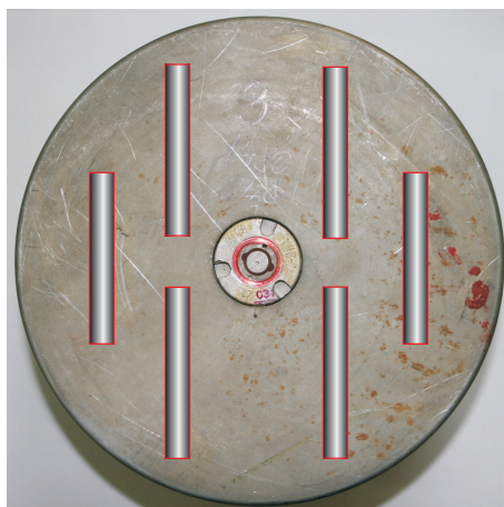
Rys. 4. Schemat pobrania próbek materiałowych z okucia
